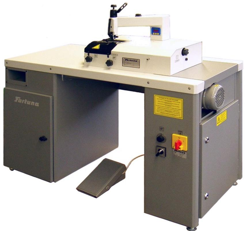
Mit der ES 50 können diverse Materialien wie Leder, lederähnliche Materialien, Verbundwerkstoffe, Kunststoffe etc. bearbeitet werden. Die optimale Anpassung der Vorschubgeschwindigkeit an Werkstoff, Schärffkontur und Bedienerfertigkeit vermeidet Ausschuss.
